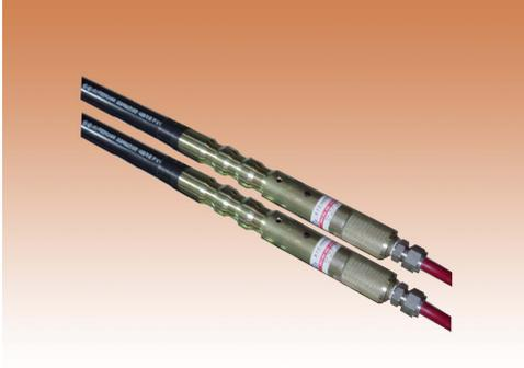
터널 굴착으로 인해 발생하는 주변 암반의 변위 거동을 파악하여 이완 영역의 유무와 크기를 산출하며 락 볼트 적정 길이를 파악하고, 집중(수렴)으로 인한 주변 지반의 변위, 사면의 변형 및 흩이나 암반의 수직 변위를 측정하는데 유용한 전기저항식 지중 변위계이다.
