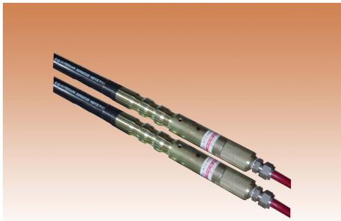
터널 굴착으로 인해 발생하는 주변 암반의 변위 거동을 파악하여 이완 영역의 유무와 크기를 산출하며 락 볼트 적정 길이를 파악하고, 집중(수렴)으로 인한 주변 지반의 변위, 사면의 변형 및 틀이나 암반의 수직 변위를 계측하는데 유용한 전기저항식 지중 변위계이다.
